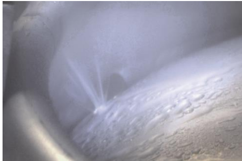
Keg mit geöffneter Sicherheitsberststelle
